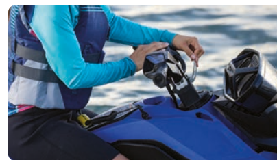
Manubrio con montante regolabile Un sistema di sterzo telescopico che ottimizza l'esperienza per piloti di altezze differenti.
